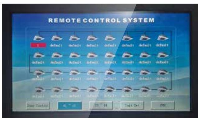
Центральный контроллер позволяет организовывать индивидуальное управление кондиционером в зоне кондиционирования и управление группой кондиционеров из одного диспетчерского пункта. Центральный контроллер позволяет задавать как индивидуальные параметры работы для каждого кондиционера, так и общие для всей системы. Максимальное количество подключаемых единиц – 64.
