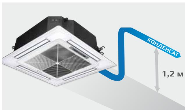
Все кассетные блоки линии COMPETENZA укомплектованы встроенным дренажным насосом для отвода конденсата. Отвод конденсата от внутренних блоков происходит с помощью данной встроенной опции (высота подъема конденсата для моделей 950×950 до 1200 мм, для моделей 650×650 до 800 мм) – это максимально облегчает монтаж и делает выбор места установки кондиционера намного более гибким и удобным для последующей эксплуатации.
