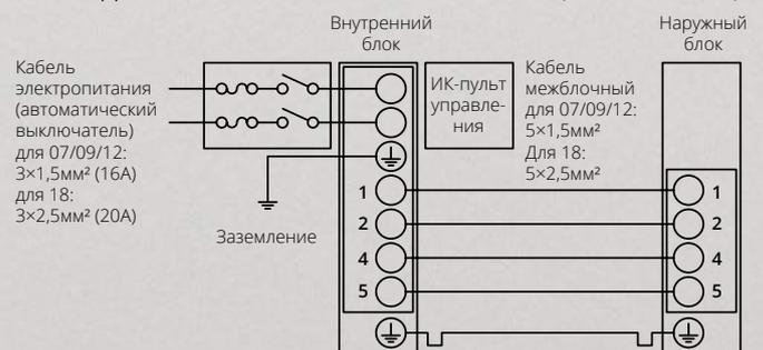
Схема подключения Prime series On-Off (24/36)
